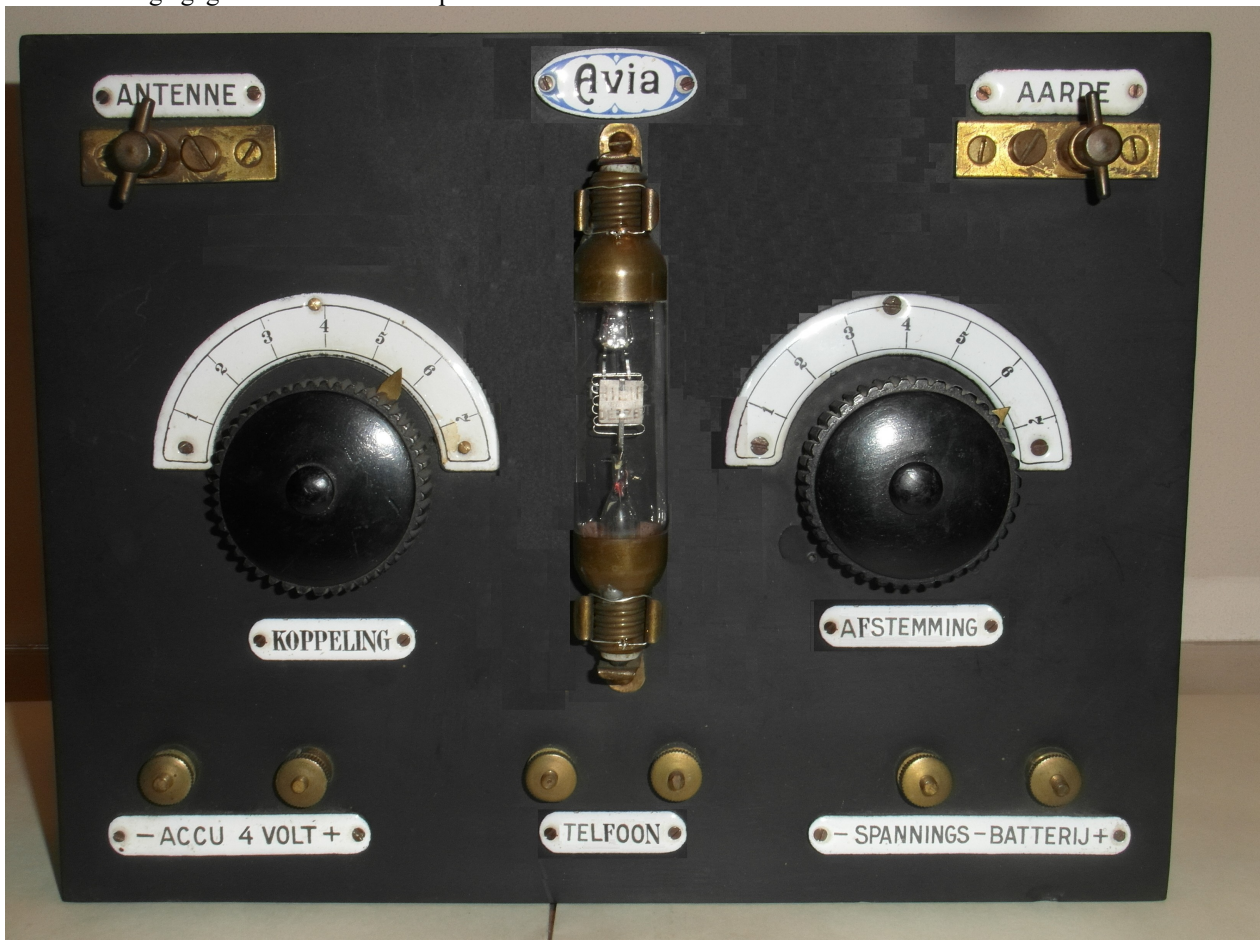
Een reconstructie van de voorplaat van de eenlamps Avia. Vermoedelijk dezelfde afmetingen en uitvoering als de tweelamps Avia. Type LJ4?
